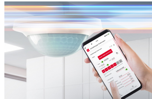
Der Präsenzmelder COMPACT APC20 steuert mit integrierter DALI-2-Steuereinheit bis zu 64 Betriebsgeräte in bis zu 16 Gruppen – bei Bedarf auch abhängig von Wochentag und Uhrzeit.
